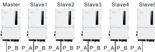
Abbildung 3.23 Parallelschaltung von Klemmen
