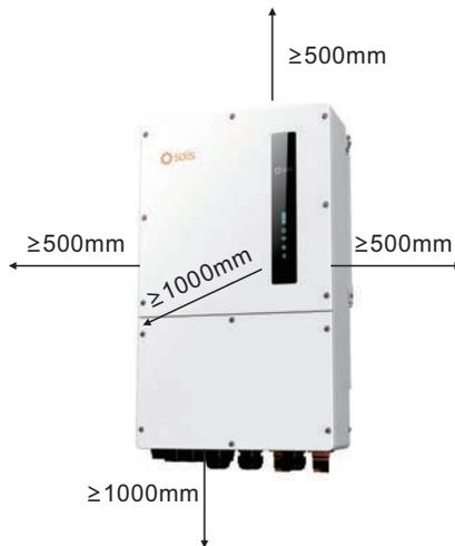
Abbildung 3.5 Montageabstände des Wechselrichters
