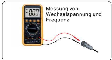
Schritt 2: Schalten Sie die OCPD für das System ein und messen Sie dann die Wechselspannungen von Leitung zu Leitung und von Leitung zu Nullleiter. Die Reserveseite des Systems ist bis zum Abschluss der Inbetriebnahme ausgeschaltet.
