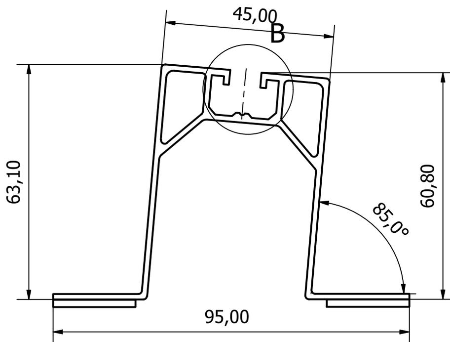
Abb.1 Abmessungen des Elements K-56
